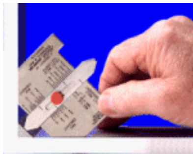
Comprobación garganta del cordón en ángulo
